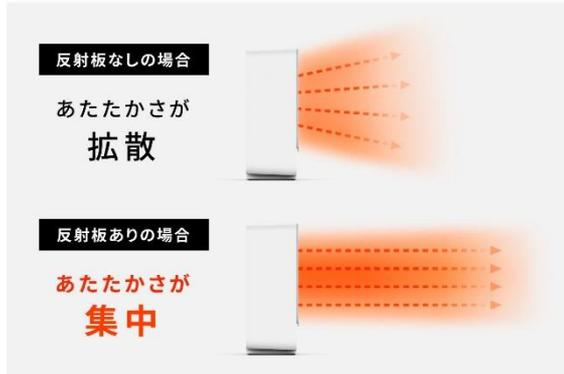
本体背面を向いたヒーターの熱を反射板で反射させることで、熱がお部屋全体に拡散することなく、前方に集中。欲しいところに集中的にあたたかさを届けることができ、600Wの消費電力で、2倍の1200W相当のあたたかさを実現しました。
