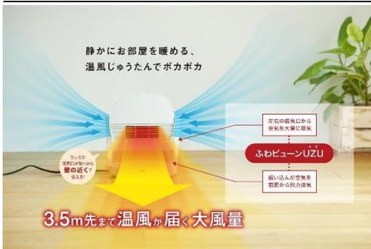
本体左右の吸気口から空気を取り込み、本体前面から送風する「ふわビューン UZU (うず)」により、温風は約3.5m先まで、送風時には約20m先まで届くほどの大風量を生み出します。
