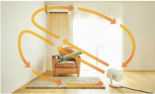
エアコンと併用することで、より快適な室内空間を作る“エアコンサポート”を実現。特に、冬場にエアコンを使う際のお悩みとして挙げられるのが、あたたかい空気がお部屋の上にとまってしまふこと。せっかくお部屋をあたためていても、サーキュレーターで空気循環を行うと、送風で身体がひんやりしてしまうことも。ポカクール「空気循環モード」は送風と温風が選べるため、冬場には温風を使用することで、肌寒さを感じることなく効率的に空気循環ができ、節電にもつながります。
