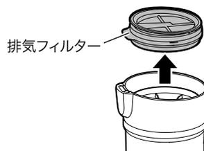
② フィルターカバーを、反時計回りに止まるまで回して引き抜く
