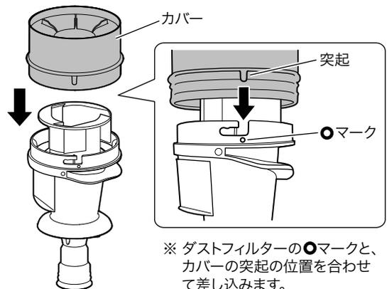
※ ダストフィルターの●マークと、カバーの突起の位置を合わせて差し込みます。
