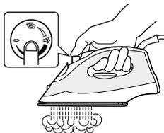
アイロンを水平にし、スチーム/ドライ切換つまみを 30 秒程度押し続けます。スチーム噴出口からスチームと熱湯が噴出します。
