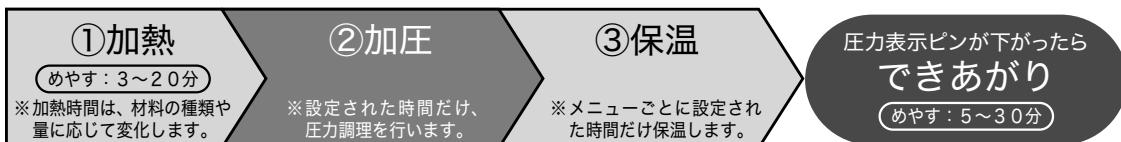
①加熱：調理を開始すると、本体内部を一定の圧力に上げるために加熱を行います。
