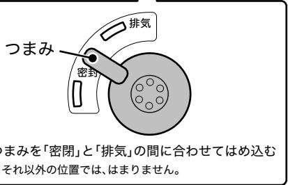
※ 圧力切替弁をはめ込んだ後、軽く引っ張って、圧力切替弁が抜けないことを確認してください。
