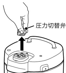
圧力切替弁をふたから取り外したあと、中性洗剤をつけたスポンジでよく洗い、水で流します。
