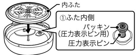
②圧力切替弁をはめ込み、軽く引っ張って、圧力切替弁が抜けにくいことを確認する。
