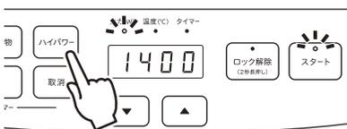
スタートのピロットランプが点灯し、ハイパワー（1400W）での加熱がスタートします。
