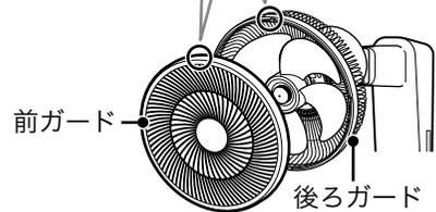
**2** 前ガードを右方向に回し、前ガードの凸部(□)と後ろガードの凸部(□)を合わせて固定する
