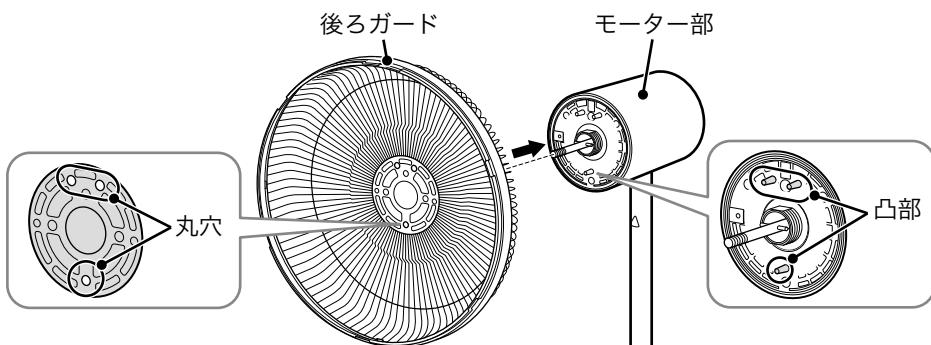
**2** モーター軸にガード留めナットを差し込み、時計回りに回してしっかりと固定する
