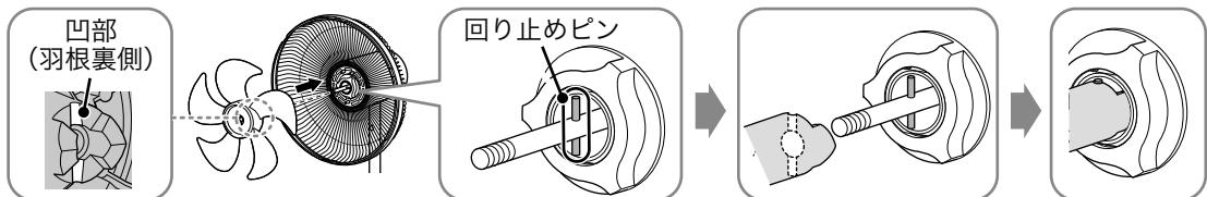
**2** モーター軸にスピナーを差し込み、「シマル」の方向に回してしっかりと固定する
