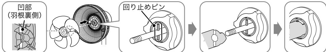
**9** モーター軸にスピナーナーを差し込み、「シマル」の方向に回してしっかりと固定する
