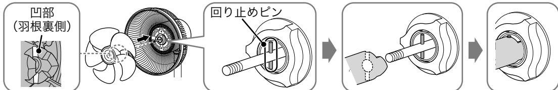
**9** モーター軸にスピナーを差し込み、「シマル」の方向に回してしっかりと固定する
