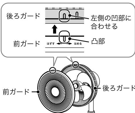
**11** 前ガードを右方向に回し、前ガードの凹部(□)と後ろガードの凸部(□)を合わせて固定する
