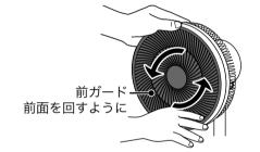
2 羽根を軽く押さえながらスピンナーを時計回りに回してはずし、羽根の中央を持って手前に取りはずす
