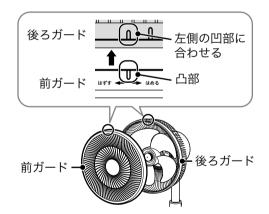
**11** 前ガードを右方向に回し、前ガードの凸部(□) と後ろガードの凹部(□)を合わせて固定する
