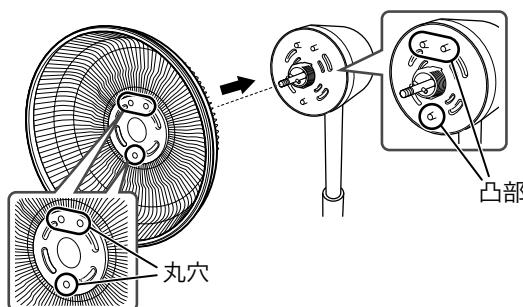
② 片手で後ろガードを押さえながら、モーター軸にガード留めナットを差し込み、右方向に回してしっかりと固定する
