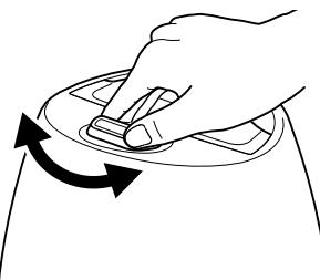
吹き出し口は、左右に回転するしくみになっており、ミストの噴出方向を調整できます。
