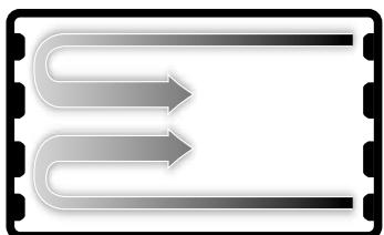
コンベクションとは、本体のファンが風を起こすことにより、庫内に熱風を循環させ、食材を効率よく焼き上げる、熱風循環式のことです。
