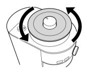
② ストッパーを押し込みながら、ひき目調節ダイヤルを持ち上げる
