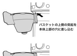
バスケットの下側の突起を 本体の溝に差し込む
