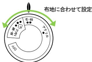
温度調節ダイヤルを回して、ご希望の使い方に応じて温度を設定します。
