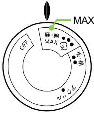
温度調節ダイヤルを回して、目盛合わせ位置に「MAX」を合わせます。
