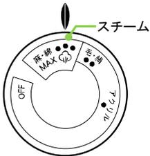
温度調節ダイヤルを回して、目盛合わせ位置に「☁ (スチーム)」を合わせます。
