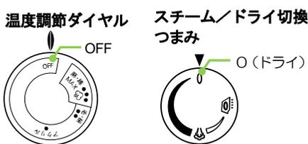
温度調節ダイヤルは「OFF」、スチーム／ドライ切替つまみは「0 (ドライ)」の位置に合わせます。
