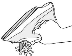
注水口ふたを開け、本体を逆さにして注水タンクに残った水を捨てます。捨て終わったら、注水口ふたを閉じます。
