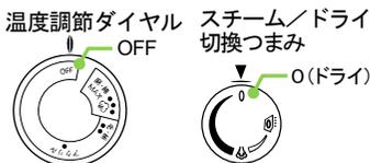
温度調節ダイヤルは「OFF」、スチーム/ドライ切換つまみは「0 (ドライ)」の位置に合わせます。
