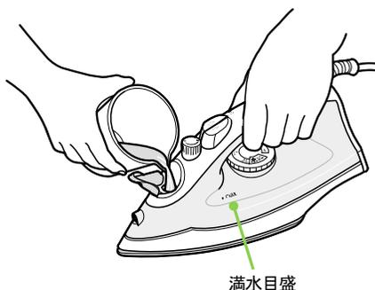
注水口ふたを開け、付属の計量カップなどを使用して、満水目盛 (MAX) の位置まで注水タンクに水を注ぎ入れます。
