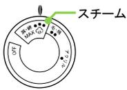
温度調節ダイヤルを回して、目盛合わせ位置に「☁ (スチーム)」を合わせます。
