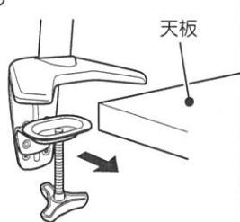
天板の厚さに合わせて、クランプの下パーツの位置を変更してください。下パーツの位置は、3 段階に調節することができます。※クランプの下パーツの位置調節の際、ネジはしっかりと締めてください。
