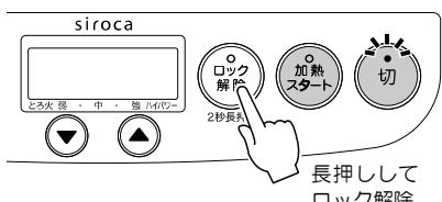
チャイルドロックが解除され、のパイロットランプが消灯します。キー操作ができる状態になります。
